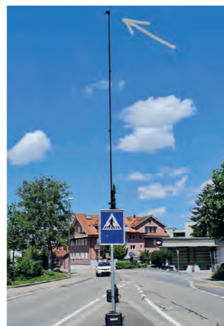
Bildlegende: so sieht eine Zählstation mit Kamera aus. Bild: Swisstraffic AG
