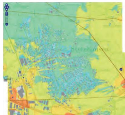
Bild links: berechnete Strahlenbelastung am Boden. Das Wohngebiet ist niedrig belastet (blau) wegen der abschirmenden Wirkung der Gebäude.
