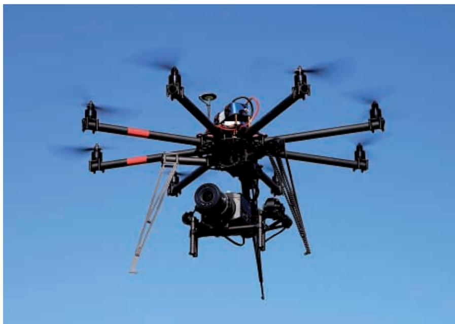
Eine Drohne oder genau ein Oktokopter, mit einer ferngesteuerten Kamera.
